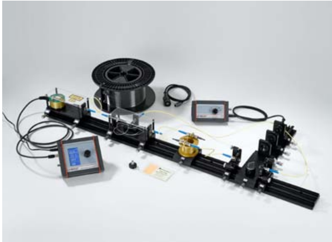
Fibre laser (P5.8.7.1)
